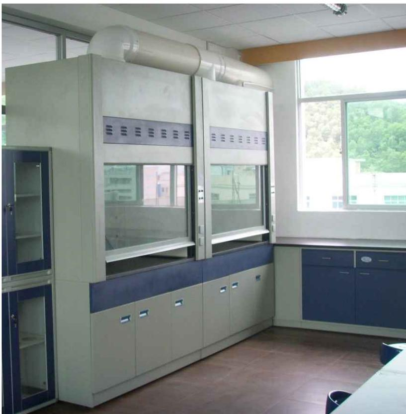
**柜体：**采用1.0mm厚优质一级冷轧钢板为基材，全自动压模成型；表面经酸洗、磷化、化学防锈处理、环氧树脂烤漆处理，无突出漆块，光洁亮丽，抗强酸强碱性能。
