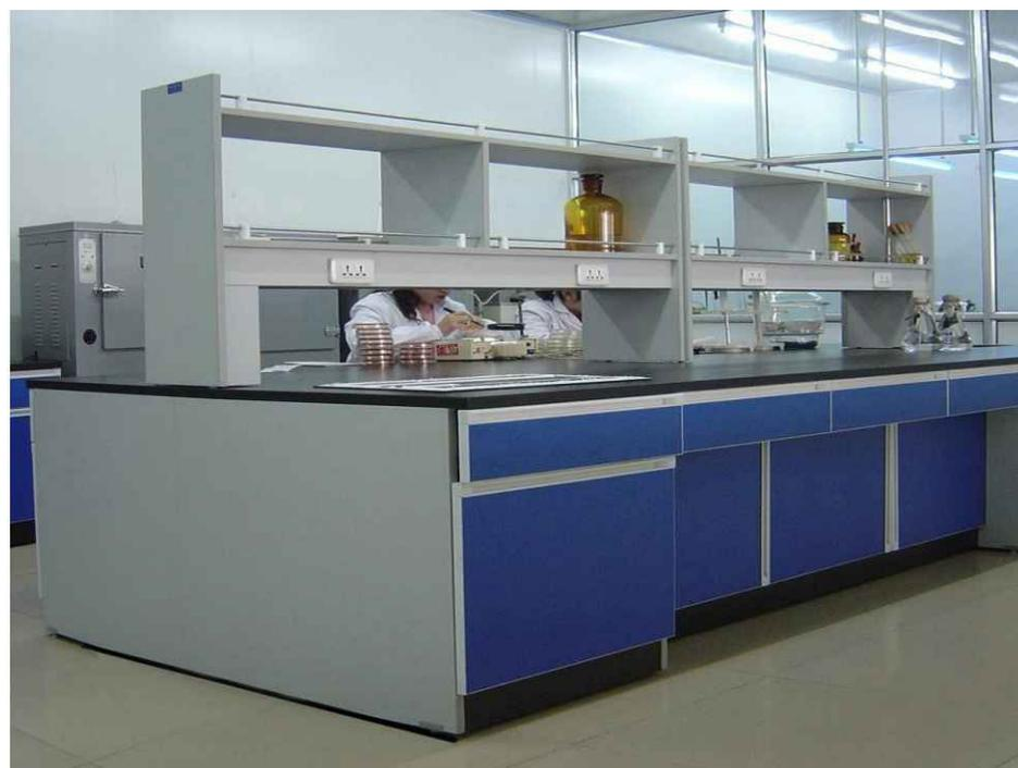
**台面：**采用实验室专用耐酸碱腐蚀台面，抑菌、易清洁，操作面前缘上边经圆滑处理，美观且光滑不伤手。
