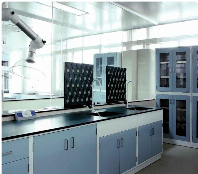
**柜体：**采用1.0mm厚优质一级冷轧钢板为基材，全自动压模成型；表面经酸洗、磷化、化学防锈处理、环氧树脂烤漆处理，无突出漆块，光洁亮丽，抗强酸强碱性能。
